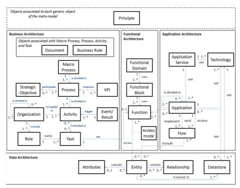
Fig. 2. ECA EA metamodel UML diagram
