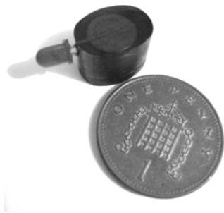
Fig. 8. In situ micro assembled mini torch
