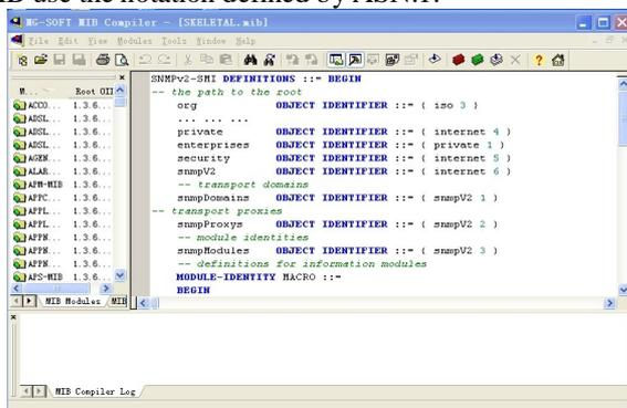
Figure 2. Definiton(skeletal) of SMI for SNMP v2
