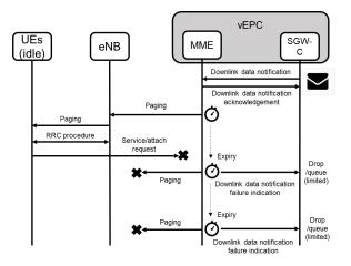
Fig. 3: vEPC paging failure
